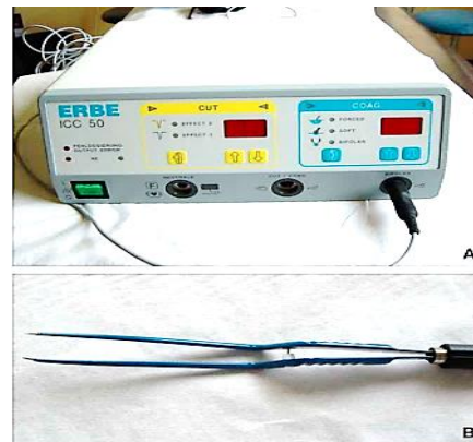
Figure 5. Matériel pour électrocoagulation A. Générateur. B. Pince bipolaire
