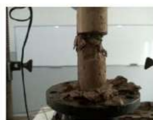
c) Rupture de l'éprouvette cylindrique
