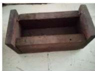
a) Moule d'éprouvette prismatique
